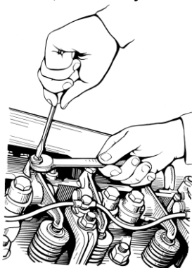
Рис. 18. Отвертывание контргайки регулировочного винта
